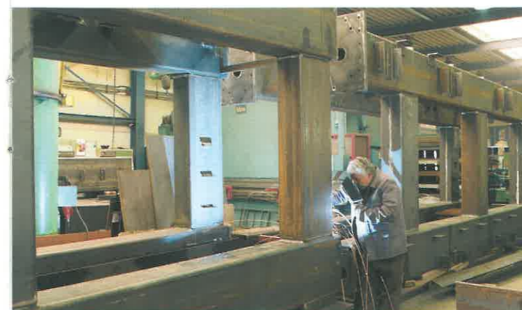
Präzisionsarbeit: Verschweißen der dickwandigen Hohlprofile zu Modulen
